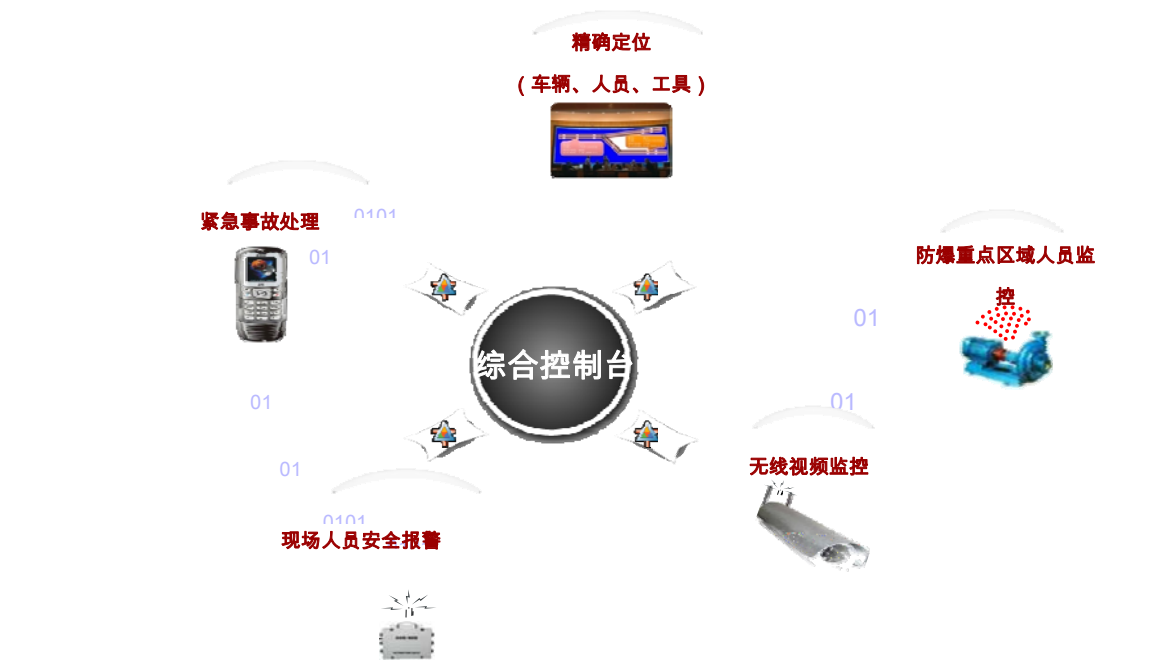
图1 综控台通过无线通讯接口维护、监控各种本安型IIC防爆AP定位终端。
