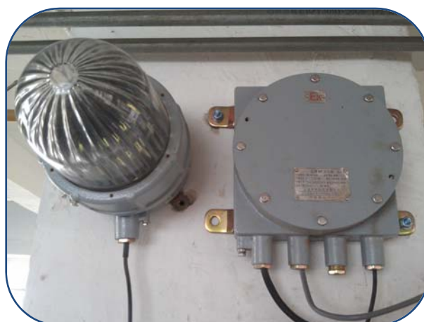
图3 本安型 IIC 防爆 AP 定位器
