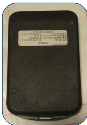
图2 本安型 IIC 防爆定位标签
