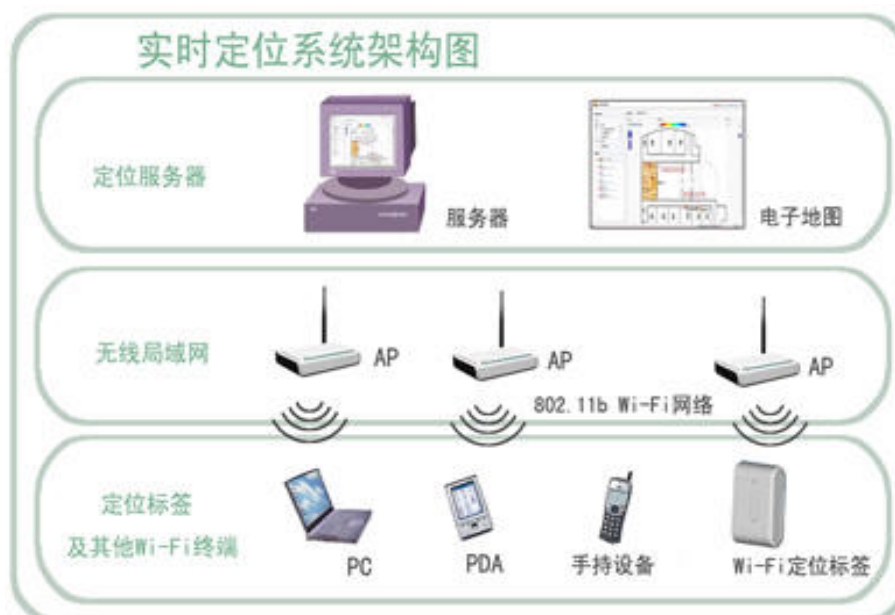
图4 定位系统网络架构图
